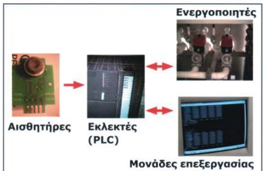
Εικόνα 2: Δομικά στοιχεία ενός BEMS
